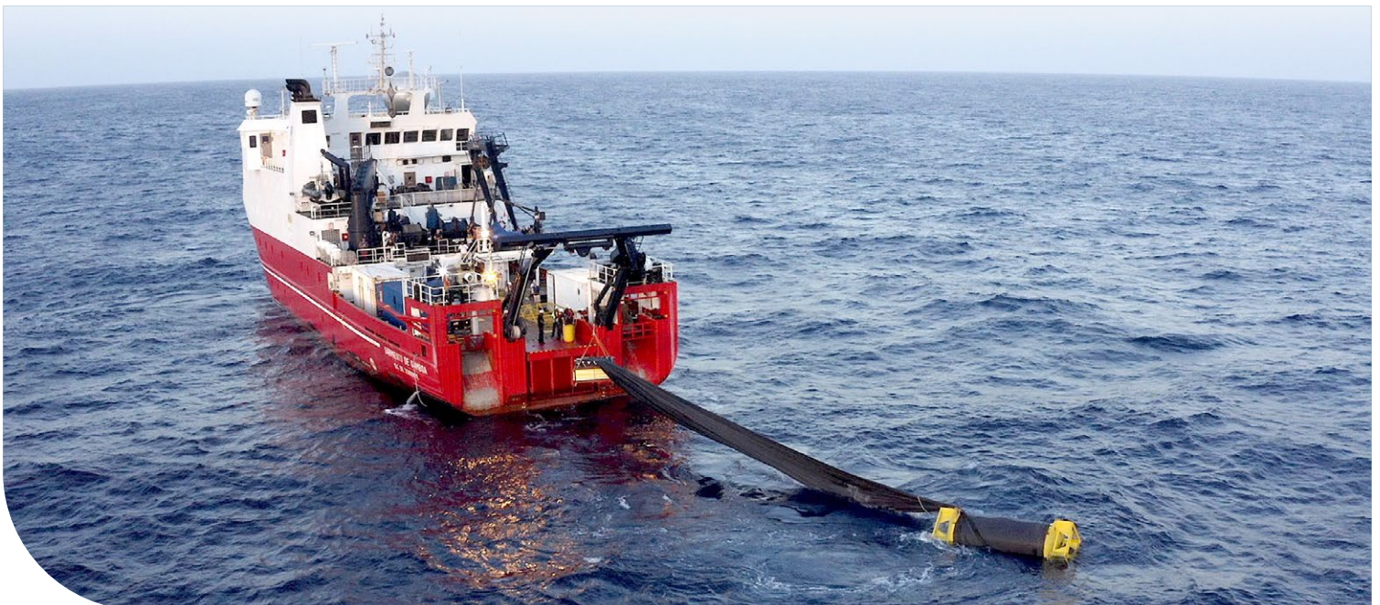
Ein spanisches Forschungsschiff setzt im November 2022 die Wellenpumpe der CDRmare-Forschungsmission für Testzwecke aus. Foto: D. Gutierrez
